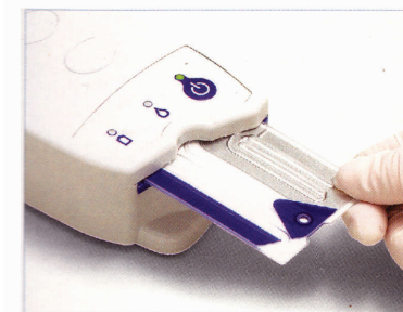
Calibración de la muestra (Tarjeta)
